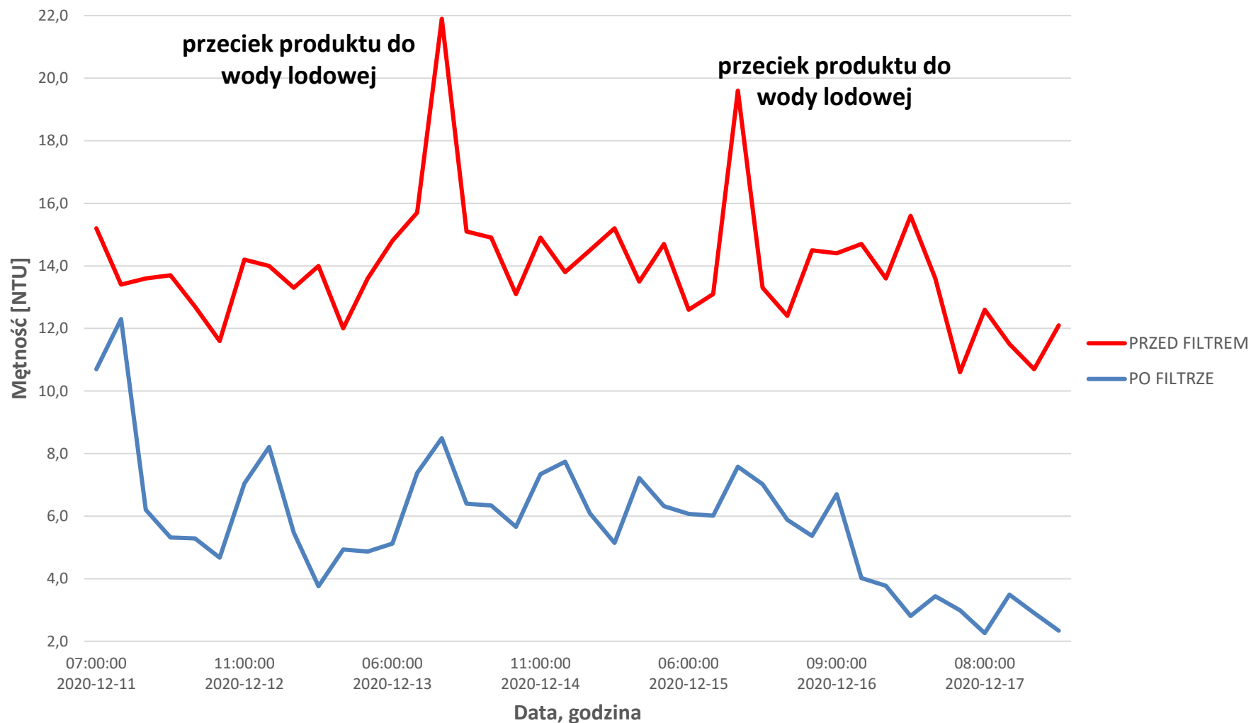
Wykres zmiany mętności w czasie 11.XII - 17.XII.2020 w układzie wody lodowej w zakładzie mleczarskim
